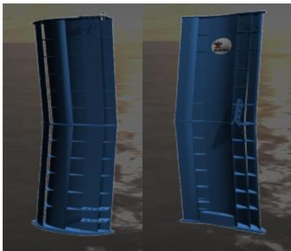
Figura 43. Puertas Thyboron Type 15 VF. Fuente: TVS.
