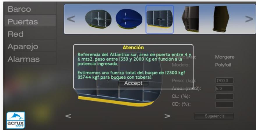
Durante la simulación vamos a poder conocer la máxima velocidad, en función a las dimensiones del aparejo y la potencia del buque.
