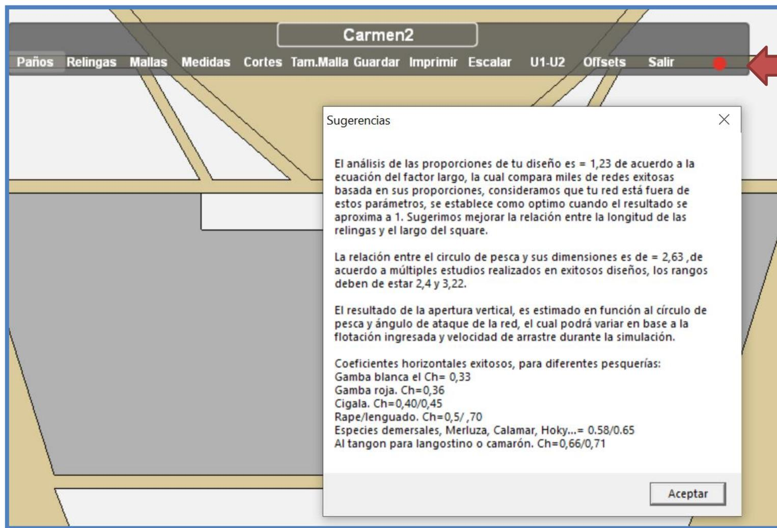
El círculo de color rojo indica que la red **no** está diseñada dentro de los parámetros generales de buen rendimiento
